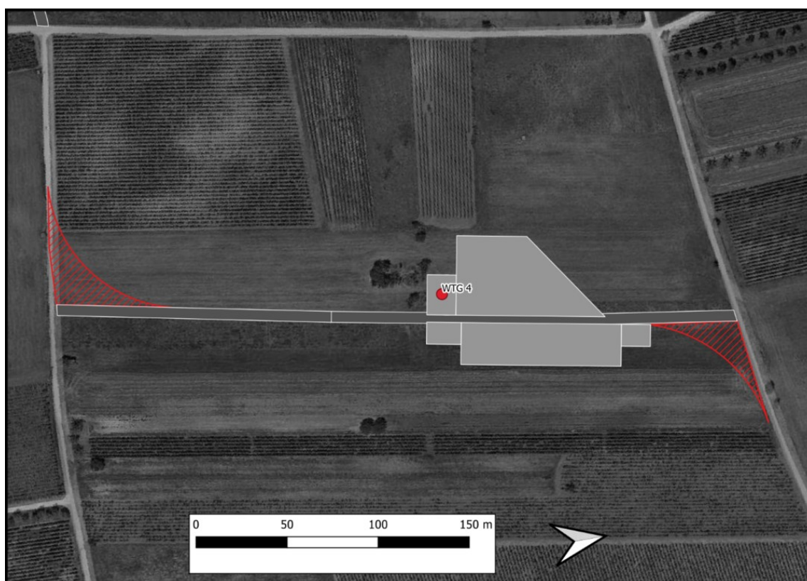
WTG 4 – Piazzola e viabilità di accesso
