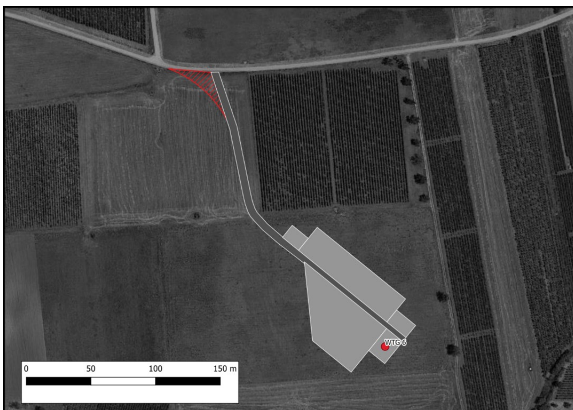
WTG 6 – Piazzola e viabilità di accesso
