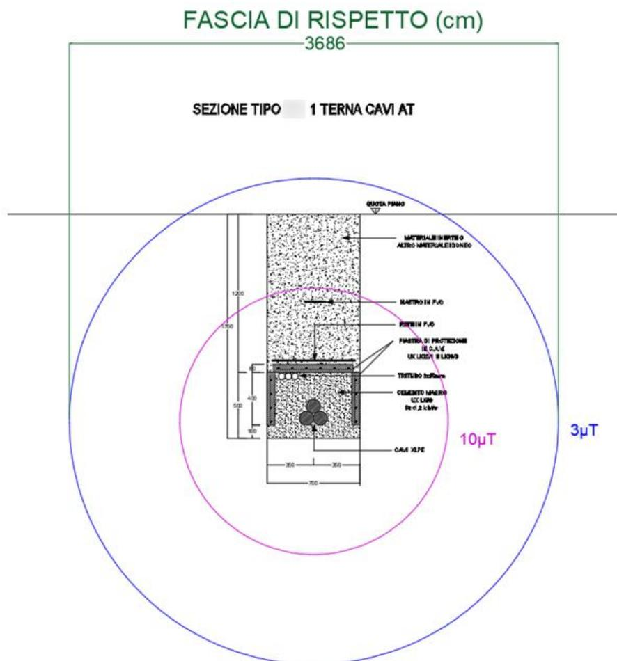
**Figura 15: Curve Equicampo -1 Terna cavi AT (su strada sterrata)**
