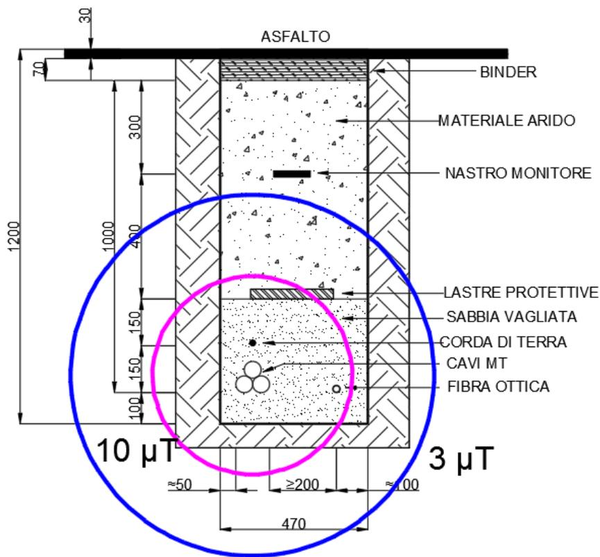
**Figura 5: Curve Equipampo –Una Terna cavi MT – Tratta 1(su strada asfaltata)**
