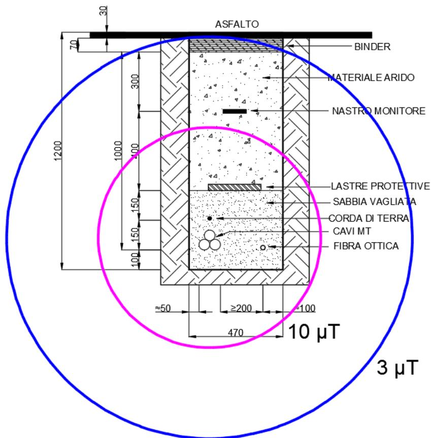
**Figura 6: Curve Equipotenziale – Una Terna cavi MT – Tratta 2 (su strada asfaltata)**
