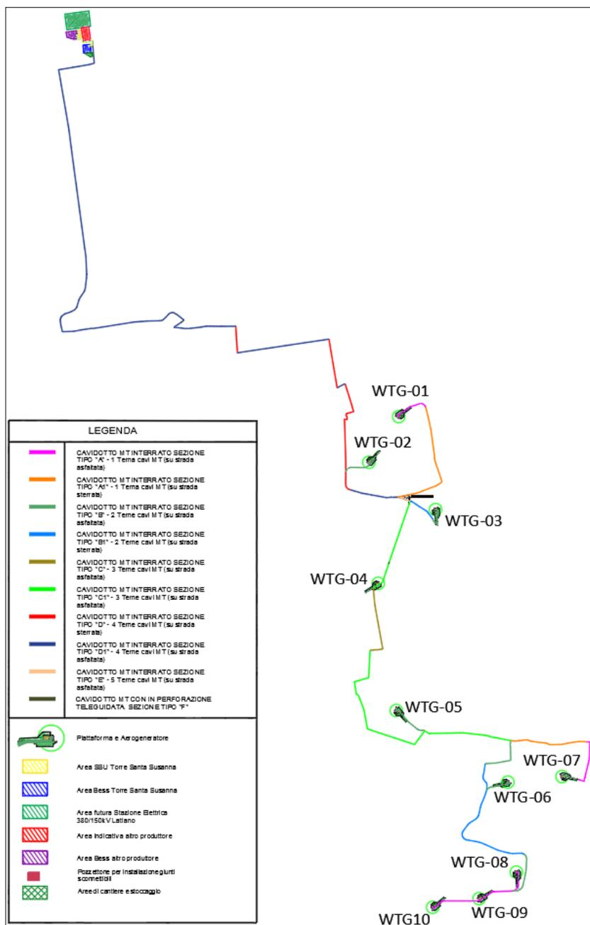
**Figura 3: Caratteristiche cavi MT interno parco**
