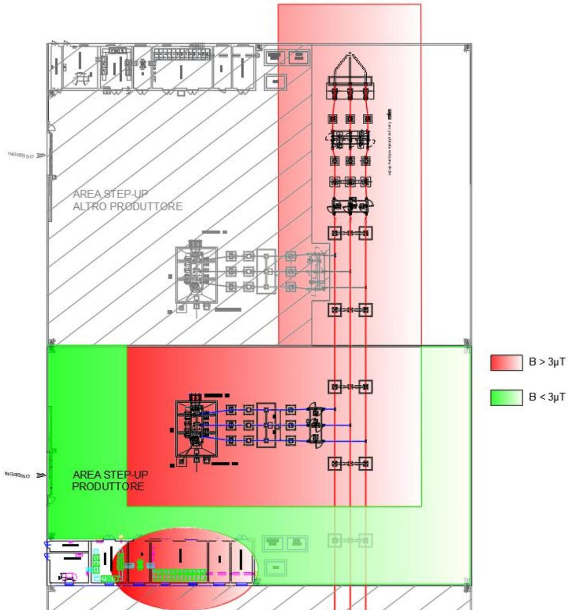
**Figura 16: Limiti di esposizione all'interno dell'Area di Sottostazione**
