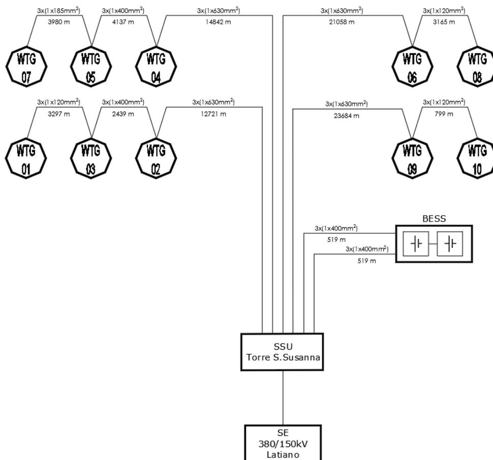
Figura 1 - Schema di collegamento tra WTG - SSU - SE
