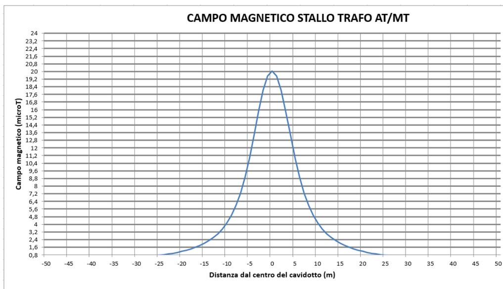
**Figura 19: Valori del campo magnetico stallo Trafo AT/MT**
