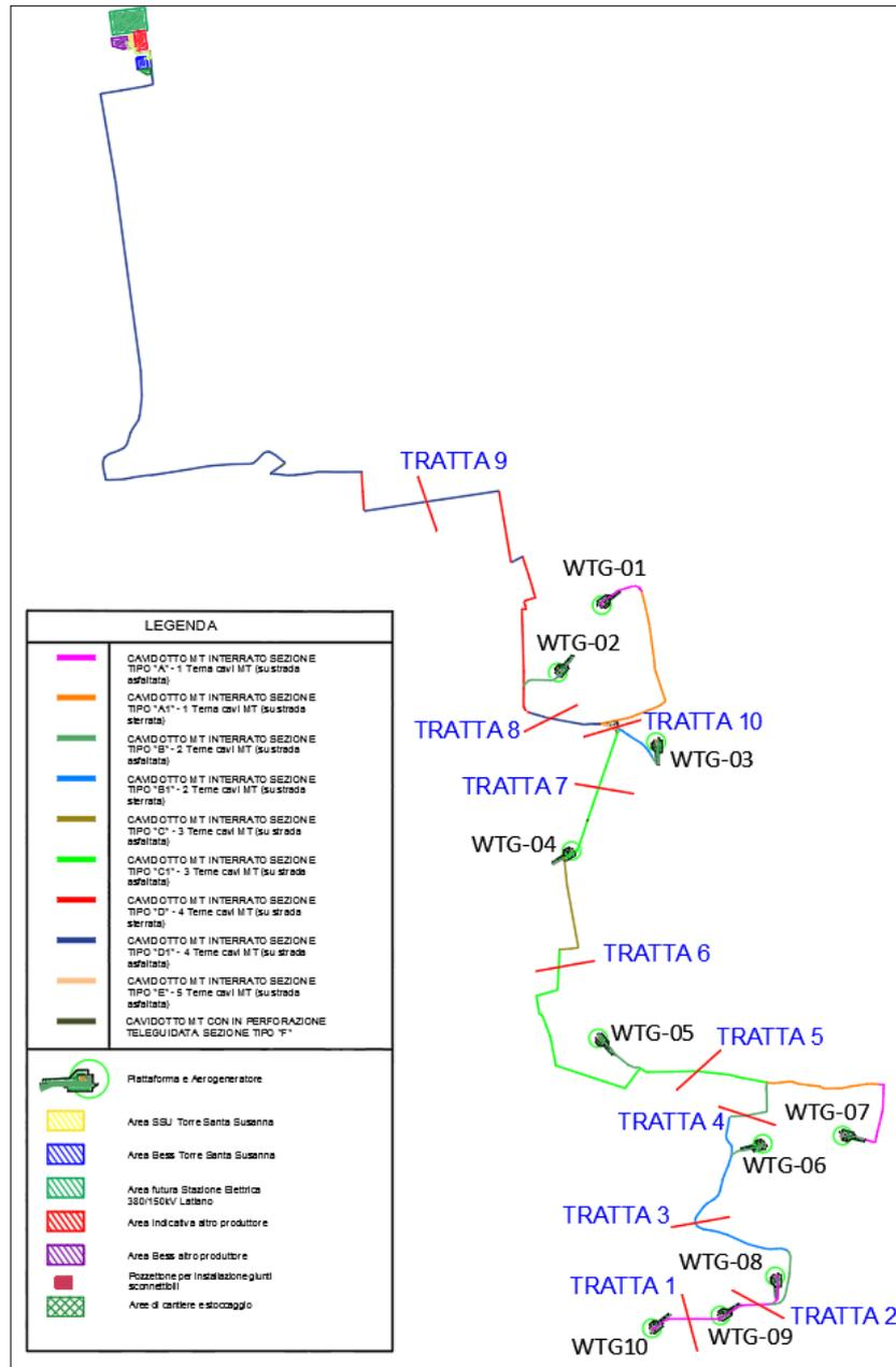
**Figura 4: Tratte del percorso del cavidotto MT studiate ai fini della valutazione dei campi magnetici**
