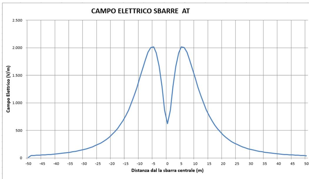
**Figura 17: Valori del campo elettrico sbarre AT**
