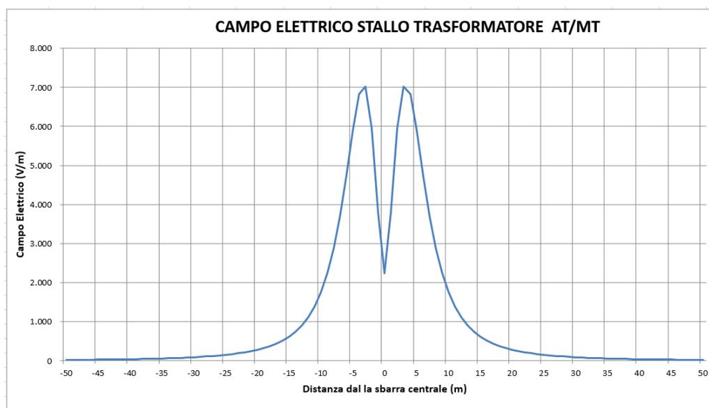
**Figura 20: Valori del campo elettrico stallo Trafo AT/MT**
