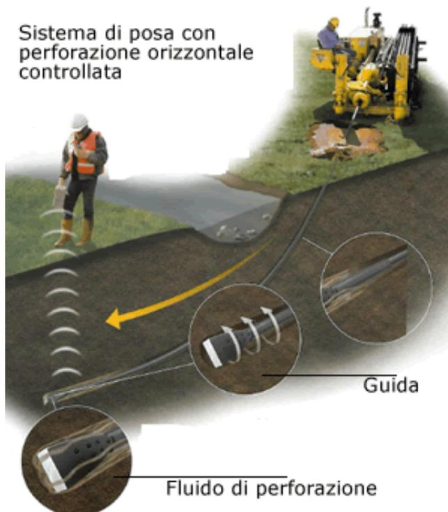
Figura 15 – Sistema di trivellazione orizzontale controllata (T.O.C.).
