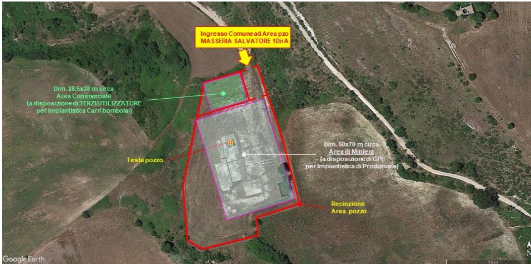
Figura 21: Area pozzo “MASSERIA SALVATORE 1DirA”. Situazione di Progetto con evidenziazione dell'impiantistica GPI (area mineraria) e dell'impiantistica UTILIZZATORE o TERZI (area commerciale).
