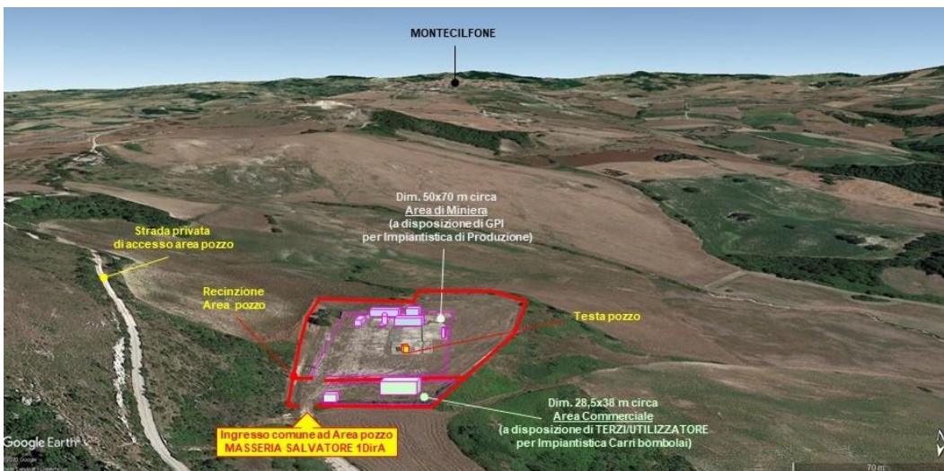
Figura 91: Rendering schematico dell'impiantistica GPI (Area Mineraria) e dell'Impiantistica utilizzatore (Area Utilizzatore).
