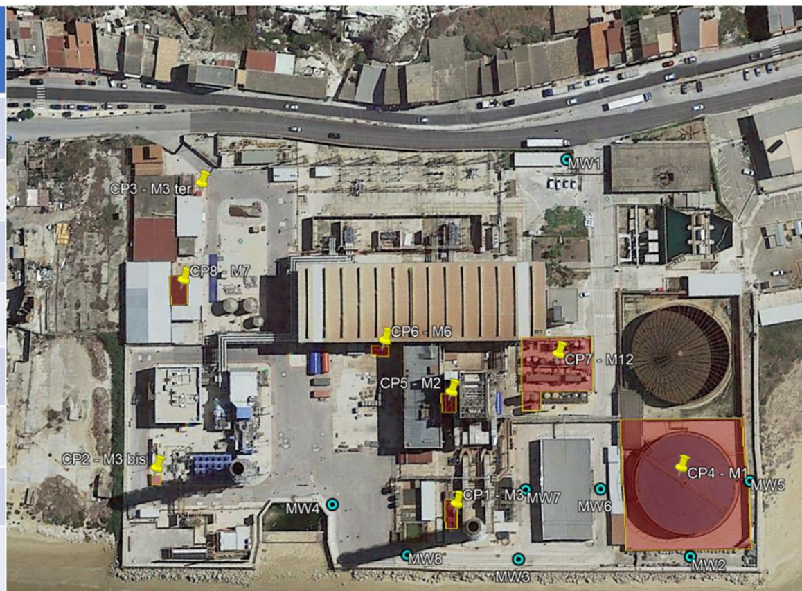
Figura 8-1 – individuazione dei “potenziali” centri di pericolo e dei piezometri esistenti scelti per fornire indicazioni circa lo stato di qualità delle acque sotterranee
