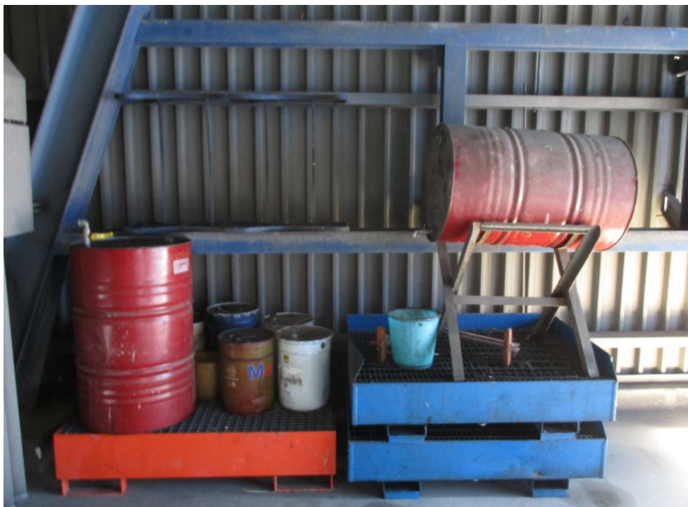
Figura 6.3: Stoccaggio Oli in Latte posizionate su Bacino di Contenimento
