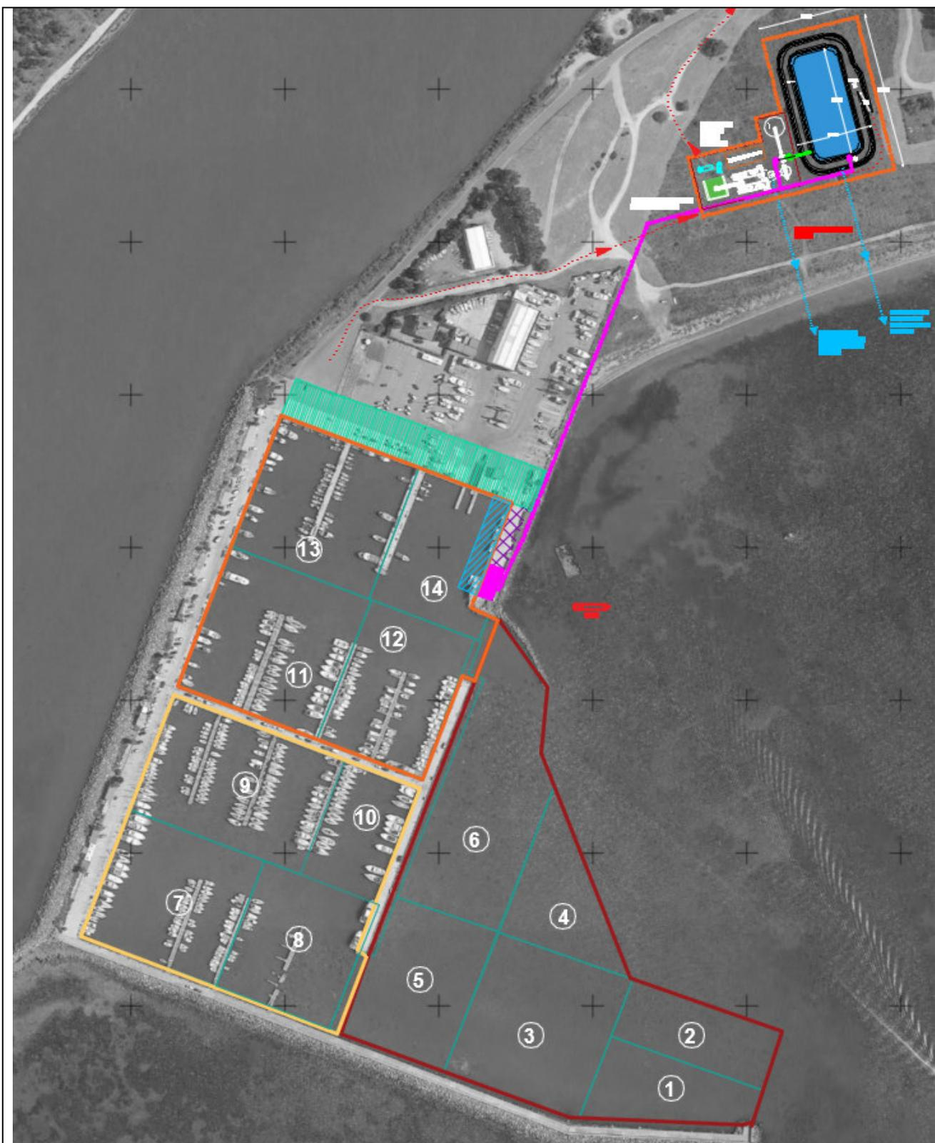
Dalla figura si evince una settorizzazione del cantiere pensata per garantire una piena e continua produttività del processo di dragaggio dalla fase di escavo a quella di conferimento in discarica.
