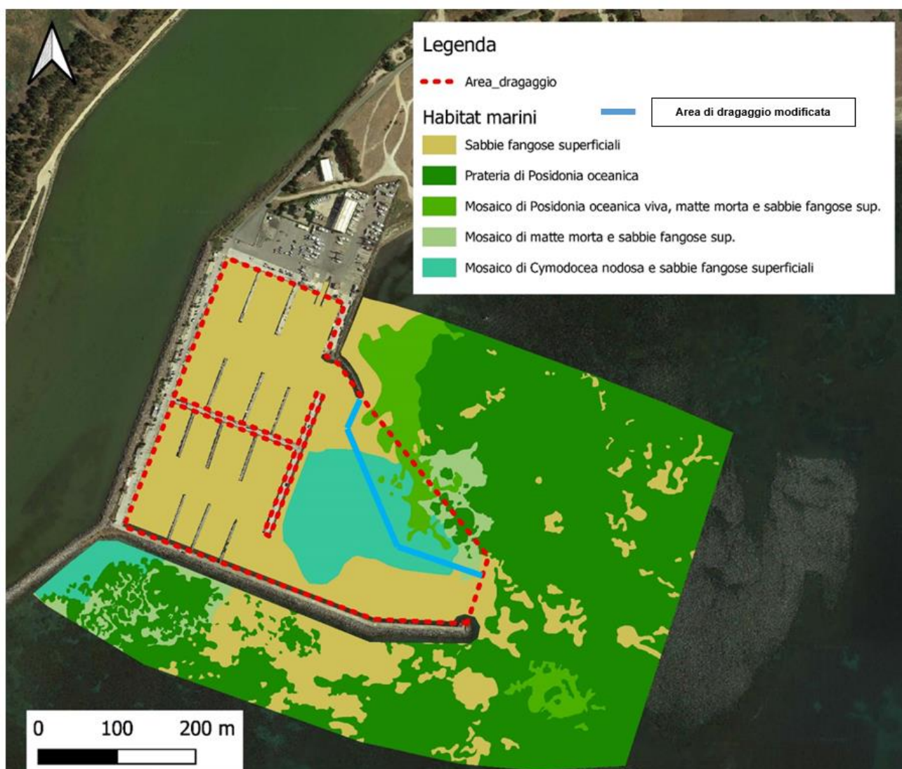
Figura 35 Perimetrazione nuova area di escavo
