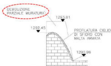
Figura 8 – Adegumento della luce sfiorante dello scarico sussidiario
