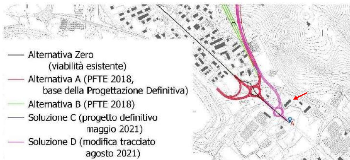
Figura 02 - Dettaglio della planimetria delle quattro soluzioni alternative di progetto allo svincolo Sud, la rotatoria Sud in progetto per le soluzioni alternative A, B e C risulta coincidente e pertanto non distinguibile nel dettaglio della planimetria, così pure per il primo tratto di galleria artificiale in corrispondenza della centrale Enel Green Power (la freccia rossa indica la residenza degli Osservanti).
