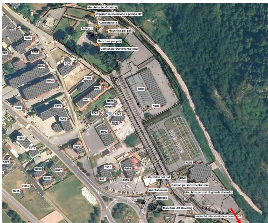
Figura 05 - Ubicazione dei macchinari sull'area di cantiere per la simulazione dell'attività cantieristica A (la residenza degli Osservanti è poco esterna all'immagine verso sud, direzione della freccia rossa).
