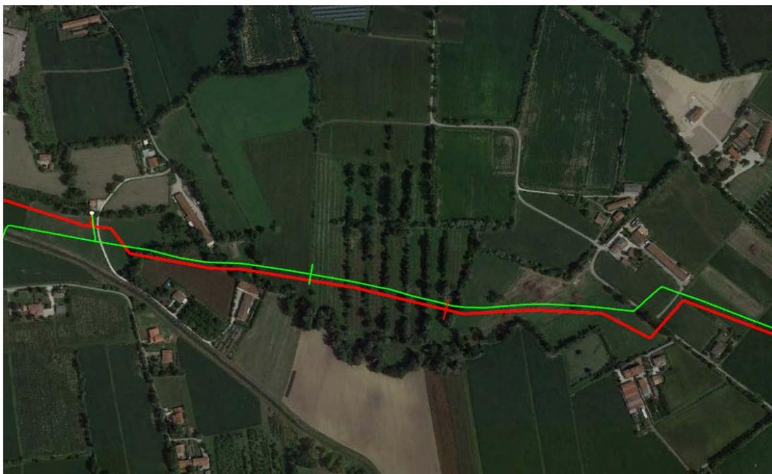
**Fig. 16** – Stralcio foto satellitare (in rosso linea in progetto, in verde linea da dismettere)
