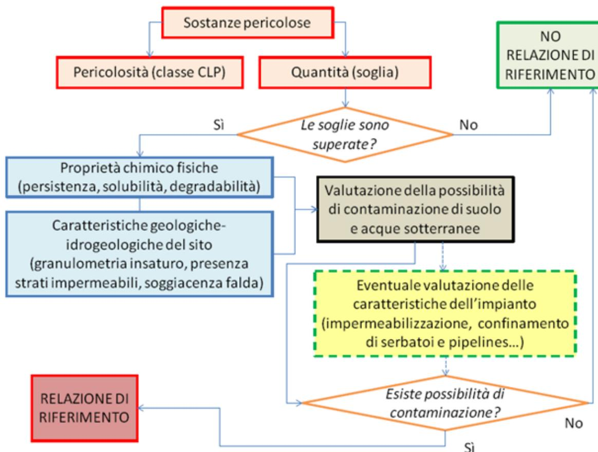
**Figura 5-1 – Diagramma di flusso per l'individuazione sostanze pericolose pertinenti**
