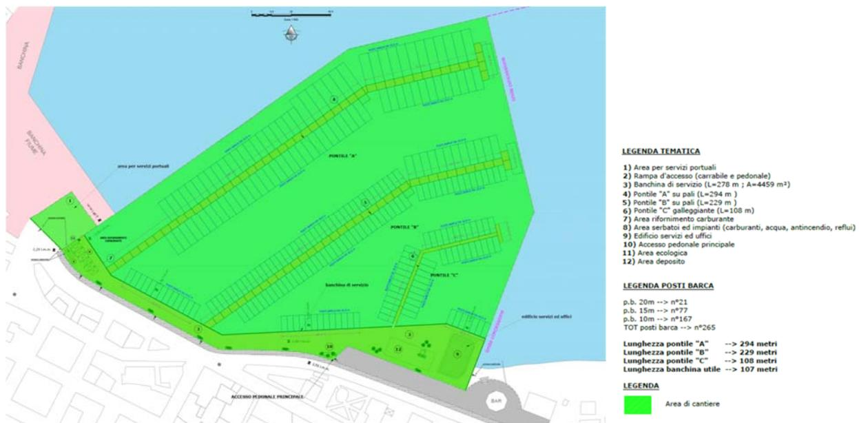
Figura 2.1 – Estratto Planimetria aree occupate in fase di cantiere coincidente con l'area richiesta in concessione demaniale
