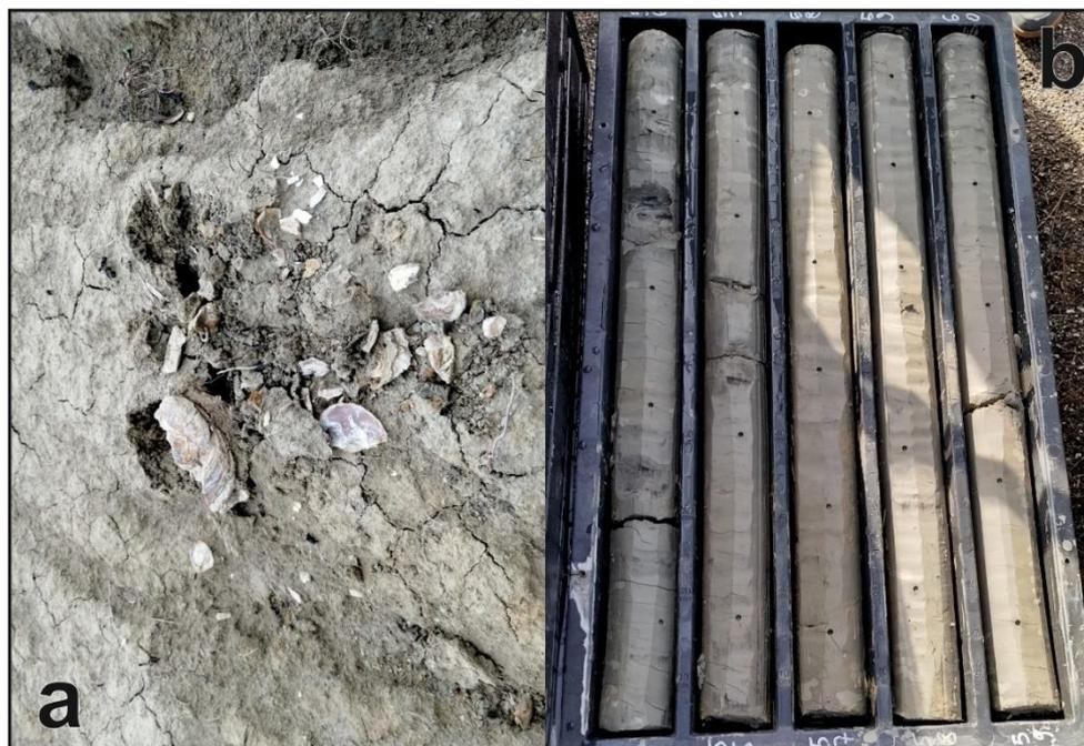
Figura 3.4. a) livello macrofossilifero nella parte sommitale delle Argille Grigio-Azzurre alla base di M. Marano (coord. 605989 E, 4523686 N); b) parte alta delle stesse nel sondaggio S3.
