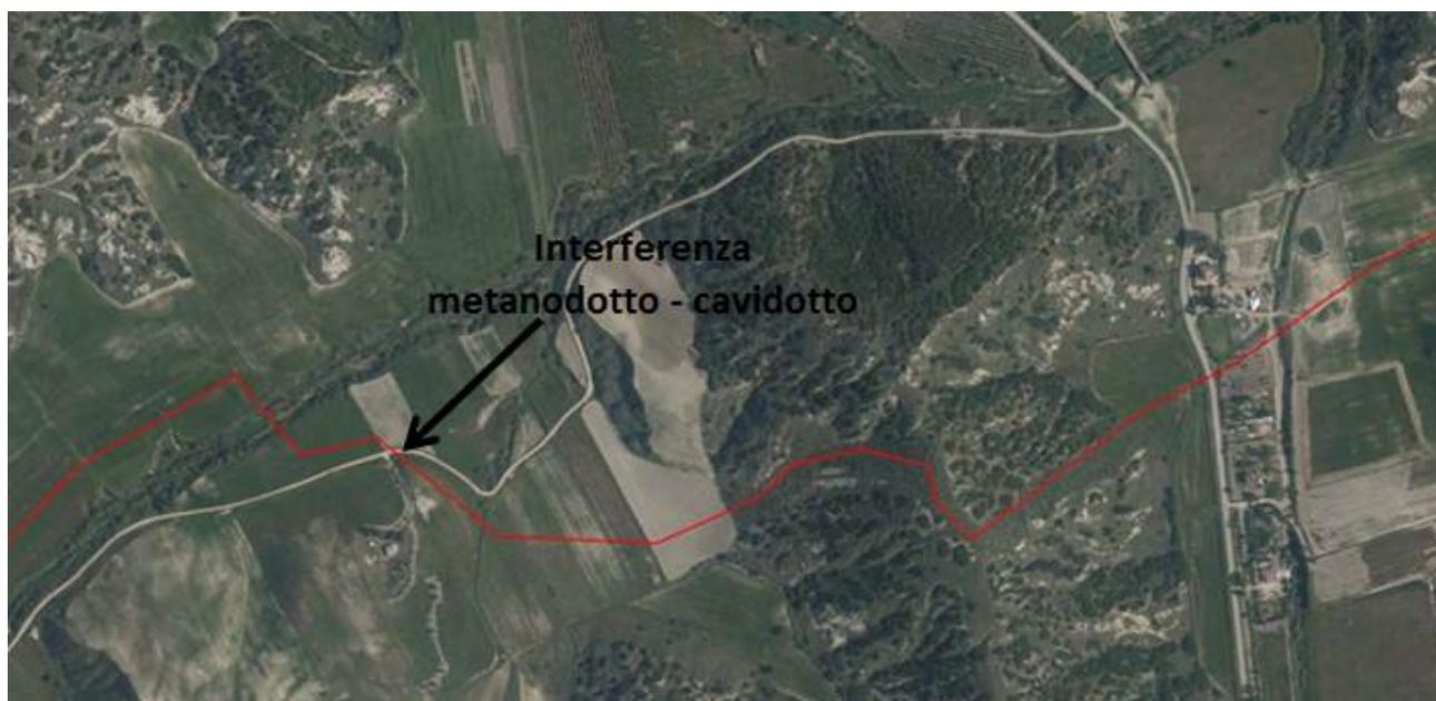
Figura 17: Evidenziato in rosso il tracciato del metanodotto SNAM, in bianco il tracciato del tratto esistente su cui si realizzerà il cavidotto
