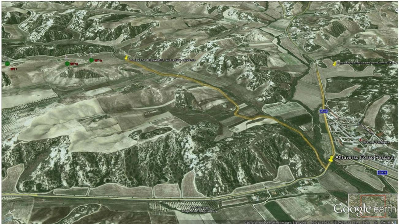
Figura 5: Percorso del cavidotto interrato, evidenziato in giallo
