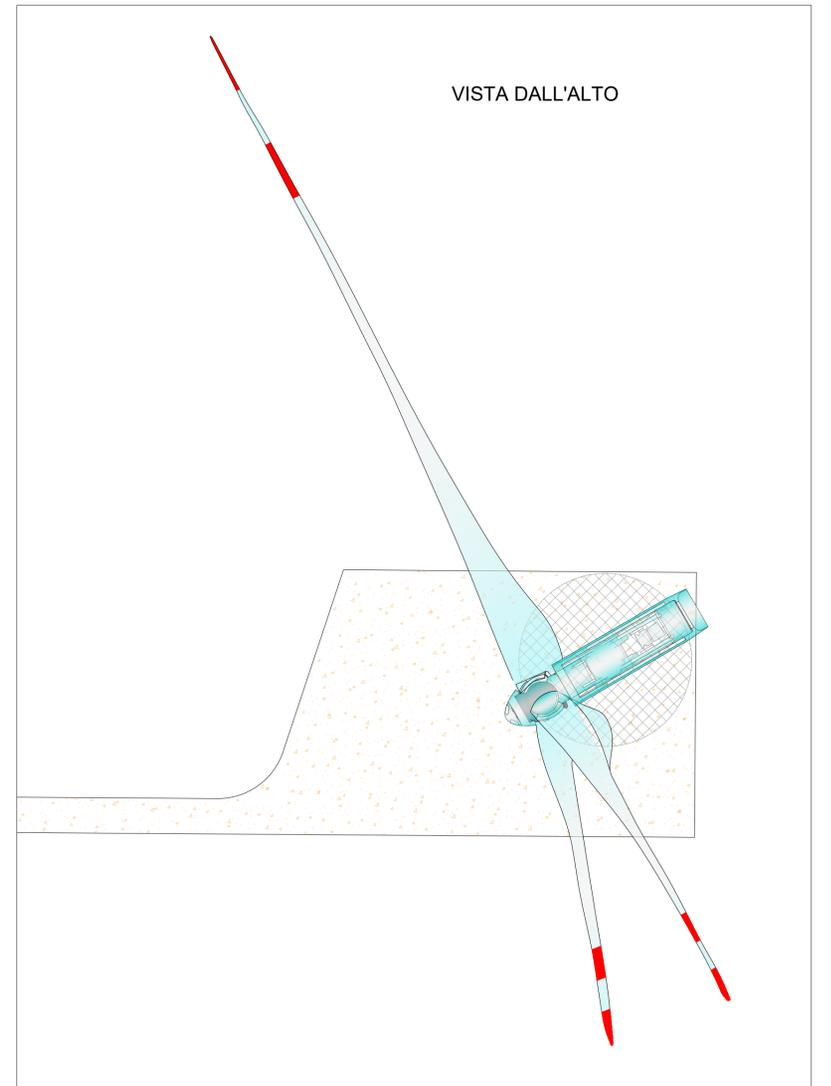
(\*) L'altezza massima al colmo dell'aerogeneratore è di 200 m, intendendo tale misura uguale alla somma dell'altezza della torre più l'altezza della pala. In base al fornitore/modello di macchina selezionato, l'altezza della torre e il diametro rotorico potranno variare rispettivamente entro questi limiti: max 126 m e max 170 m. In ogni caso la somma di torre più pala sarà tale da rispettare l'altezza massima di 200 m.
