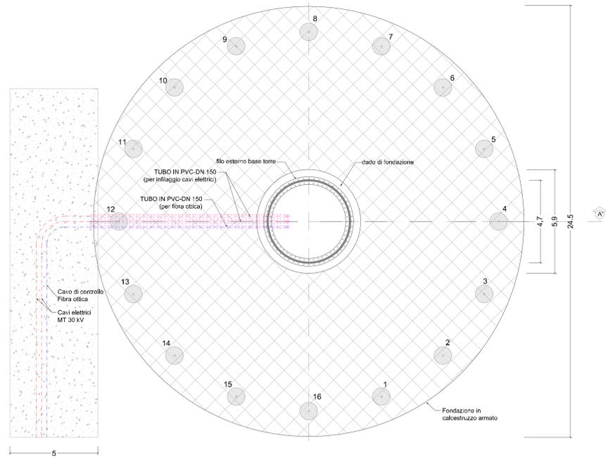
Pianta fondazione diretta aerogeneratore
