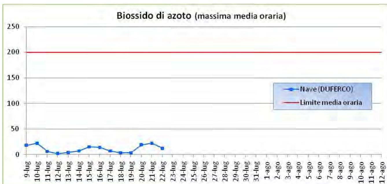
Figura A-7: Andamento delle concentrazioni massime giornaliere su base oraria di NO<sub>2</sub> misurate dal laboratorio mobile Duferco nella postazione di Nave
