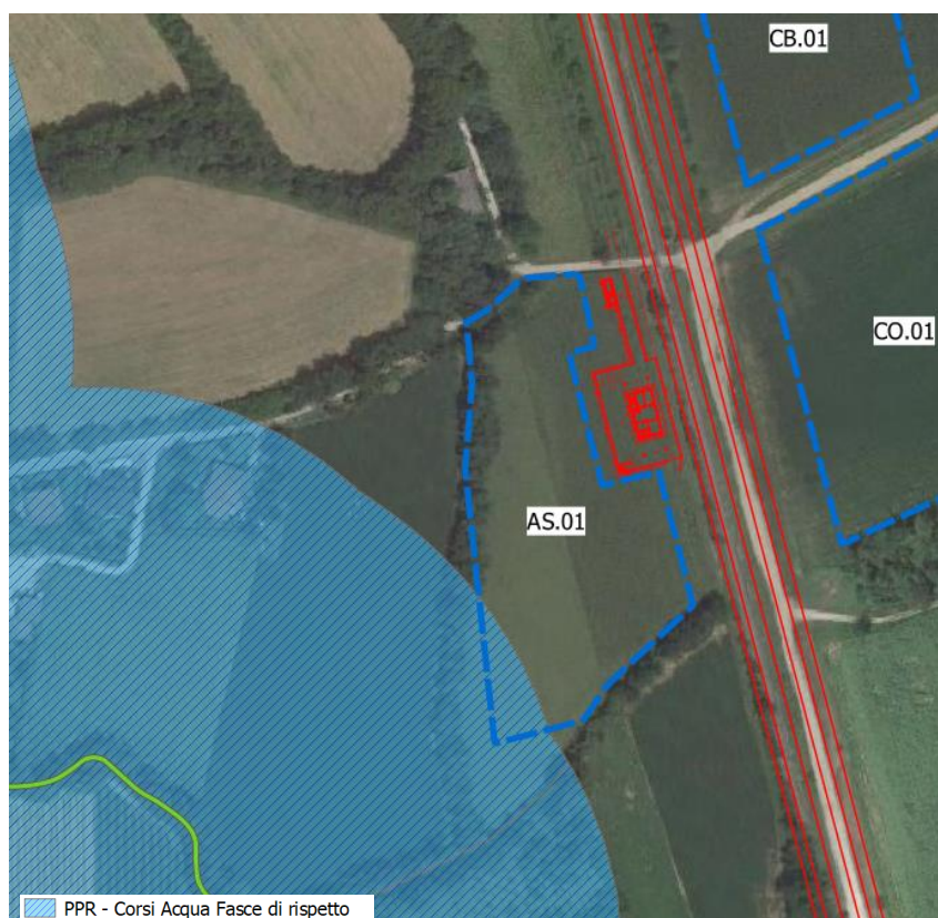
Figura 20-1 - Individuazione della porzione di cantiere AS01 ricadente in area vincolata
