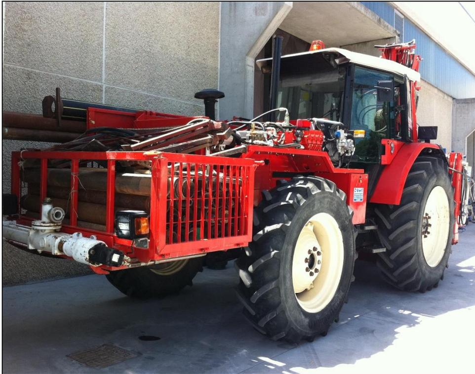
**Figura 1: Sonda Modello EK 650 – Trattore Same Antares**
