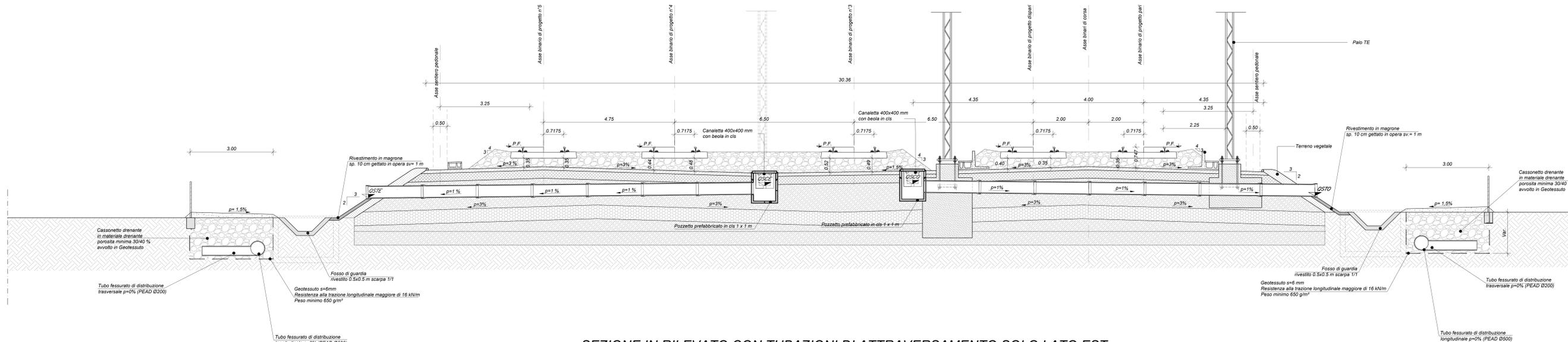
SEZIONE IN RILEVATO CON TUBAZIONI DI ATTRAVERSAMENTO SOLO LATO EST
