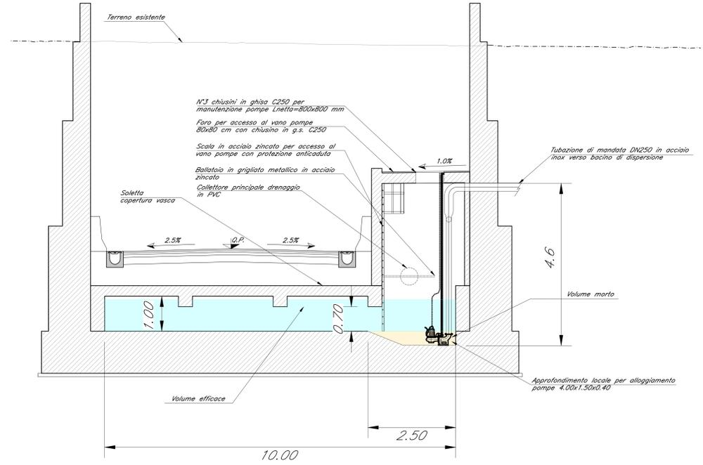
DETTAGLIO DRENAGGIO SOTTOPASSO E POZZO DISPERDENTE SL01/SL02
