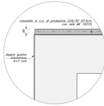
**SCHEMA DI POSA IMPERMEABILIZZAZIONE (Doppia guaina bituminosa)**
