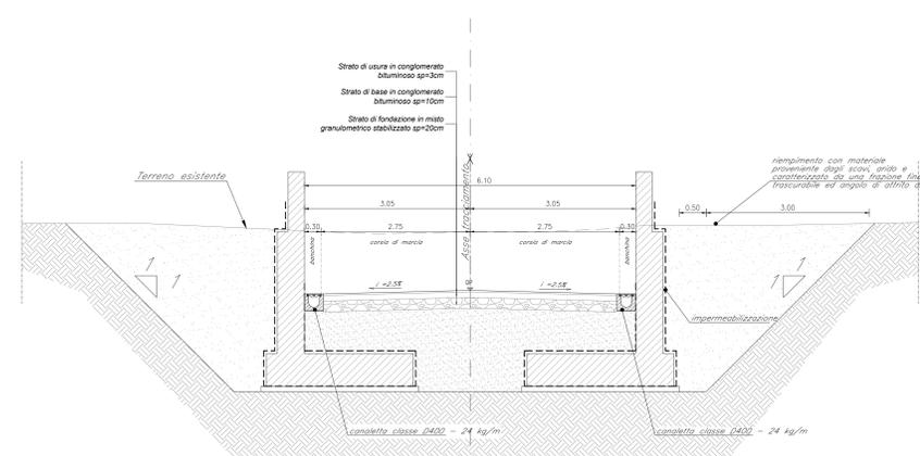
DETTAGLIO PAVIMENTAZIONE STRADALE
