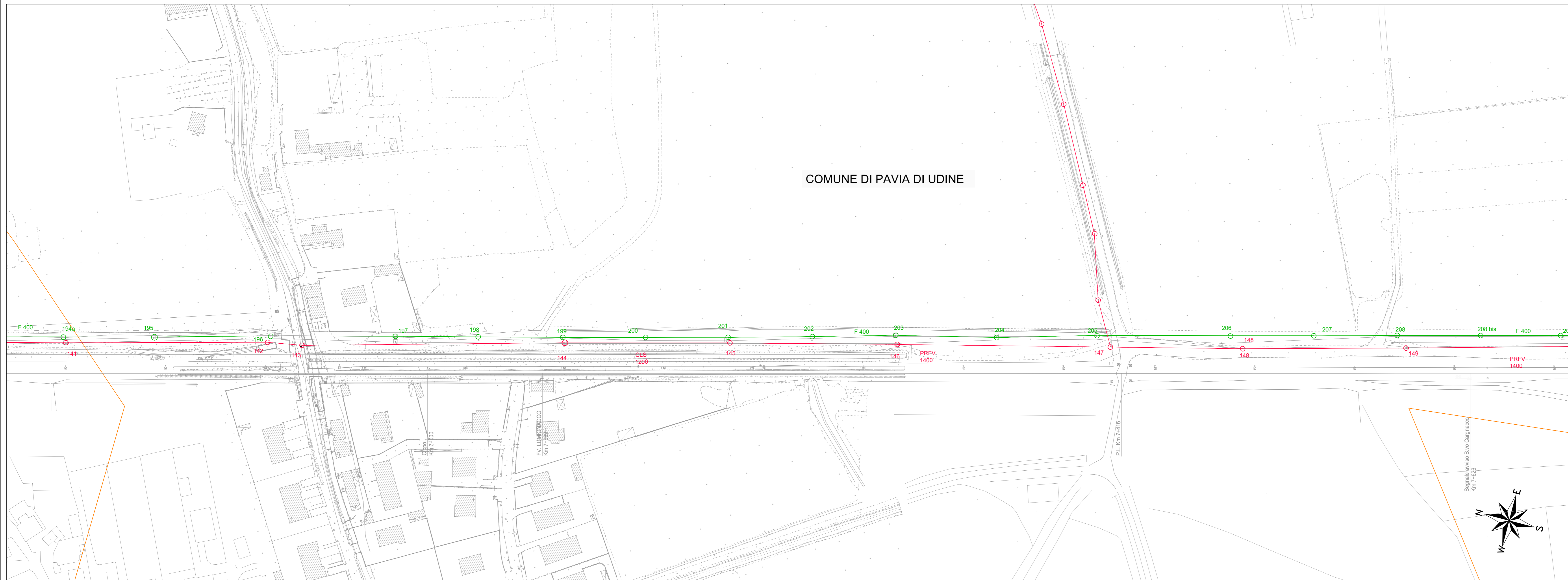
PLANIMETRIA FOGNATURA BIANCA E NERA 1/2 - SCALA 1:1000
