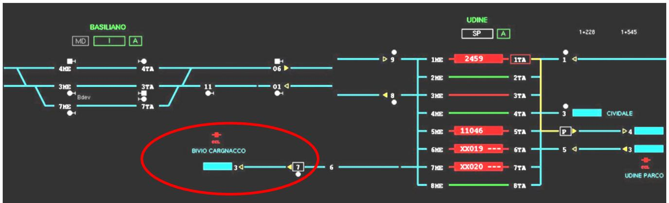
**Figura 4 – Rappresentazione attuale Bivio Cargnacco sul TD del DCO SCC 4ª sezione**
