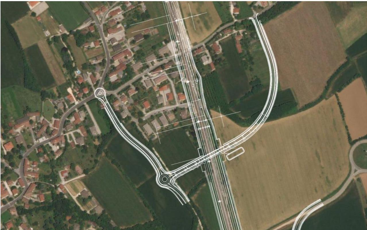
Figura 4-2 - Progetto del sottopasso SL01 e relativa viabilità di raccordo su foto area
