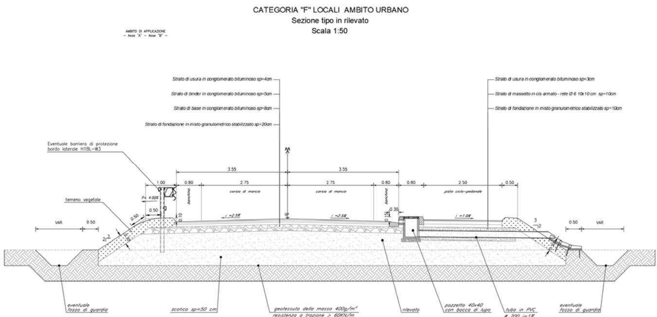
**Figura 2 - Sezione tipo in rilevato Asse A e B**
