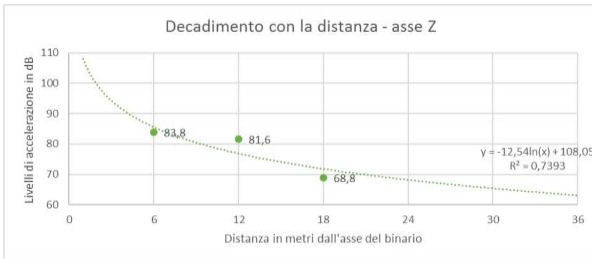
**Figura 4-9** Curva di attenuazione del  $Leq_{te}$  in funzione della distanza dal binario, ricavata dai rilievi lungo l'asse Z, in corrispondenza della Terna 1 (6metri), della Terna 2 (12 metri) e della Terna 3 (18 metri) e relativa al totale dei transiti ferroviari rilevati durante il periodo di osservazione.
