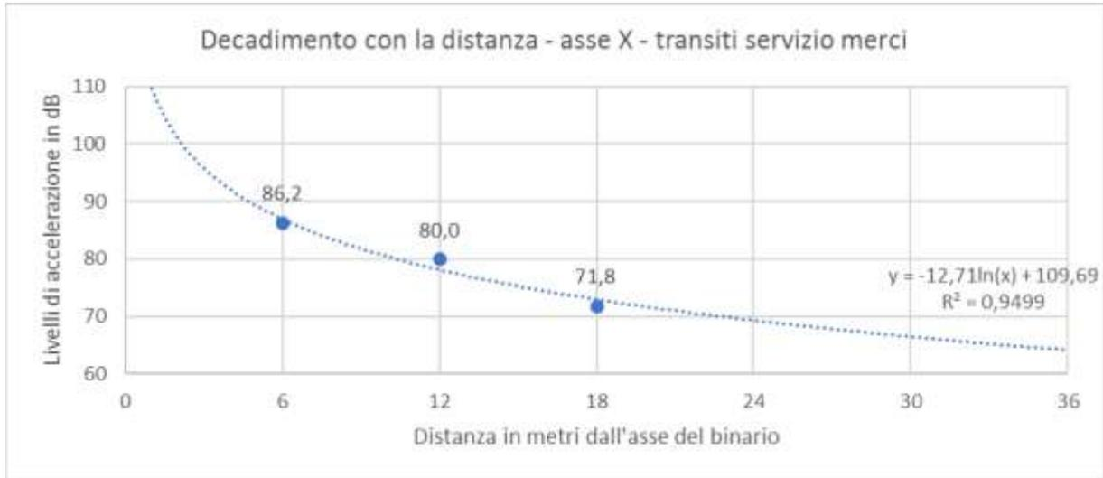
**Figura 4-4** Curva di attenuazione del  $Leq_{te}$  in funzione della distanza dal binario, ricavata dai rilievi lungo l'asse X, in corrispondenza della Terna 1 (6metri), della Terna 2 (12 metri) e della Terna 3 (18 metri) e relativa al totale dei transiti ferroviari connessi al servizio merci rilevati durante il periodo di osservazione.
