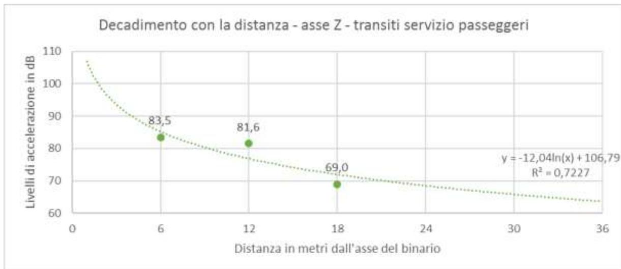
Figura 4-3 Curva di attenuazione del Leq,te in funzione della distanza dal binario, ricavata dai rilievi lungo l'asse Z, in corrispondenza della Terna 1 (6metri), della Terna 2 (12 metri) e della Terna 3 (18 metri) e relativa al totale dei transiti ferroviari connessi al servizio passeggeri rilevati durante il periodo di osservazione.
