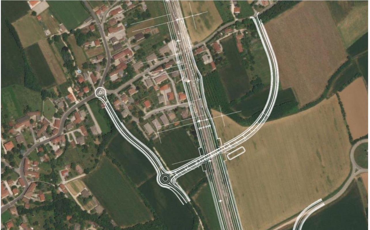
*Figura 2. Progetto del sottopasso SL01 e relativa viabilità di raccordo su foto area*
