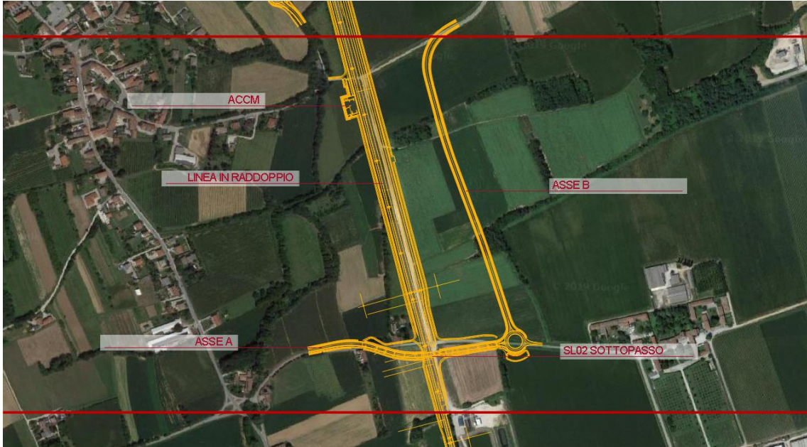
FIGURA 52 TRATTO A SUD DI LUMIGNACCO, PRESSO CORTELLO SOPPRESSIONE DEI PASSAGGI A LIVELLO E REALIZZAZIONE DELLA VIABILITÀ DI RACCORDO SOTTOPASSO SL02
