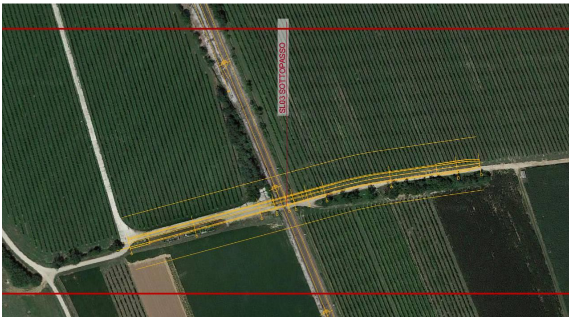
FIGURA 53 SOPPRESSIONE DEI PASSAGGI A LIVELLO E REALIZZAZIONE DEL SOTTOPASSO SL03 A RISANO
