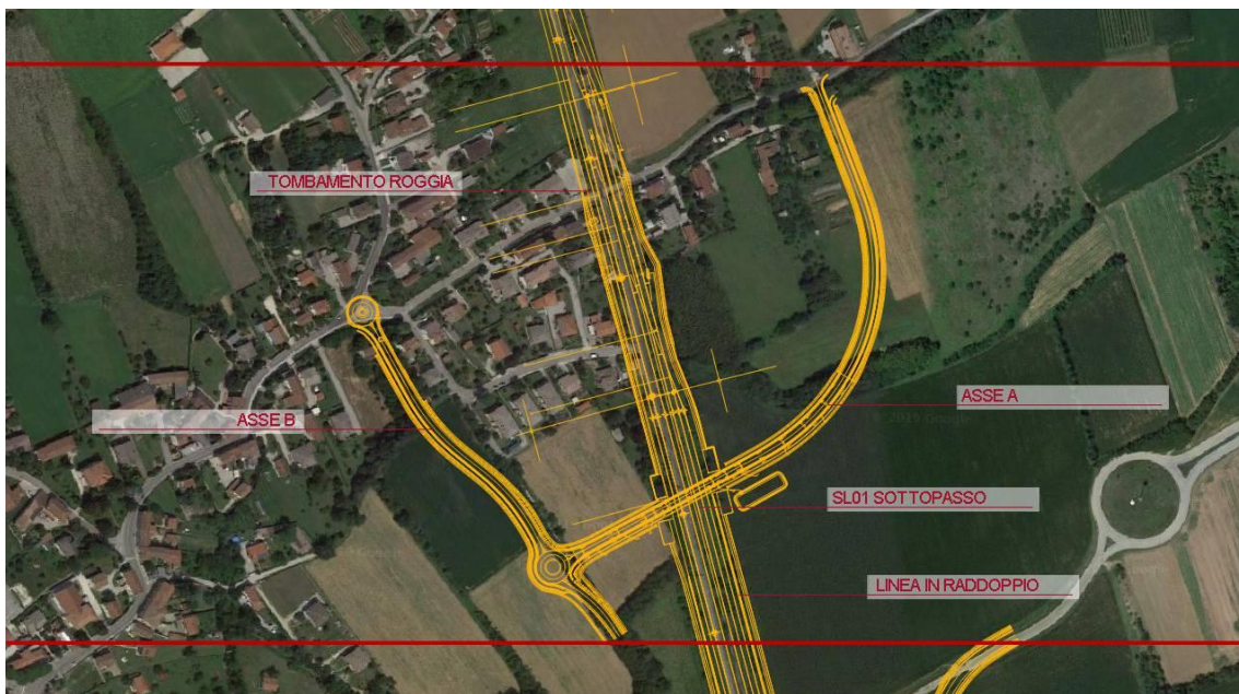
FIGURA 51 TRATTO IN LOCALITÀ LUMIGNACCO, SOPPRESSIONE DEL PASSAGGIO A LIVELLO E REALIZZAZIONE DELLA VIABILITÀ DI RACCORDO SOTTOPASSO SL01
