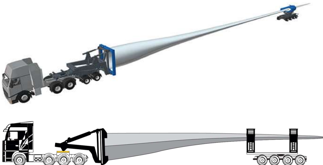
Figura 24 Esempio di trasporto pale tipologia RBTS
