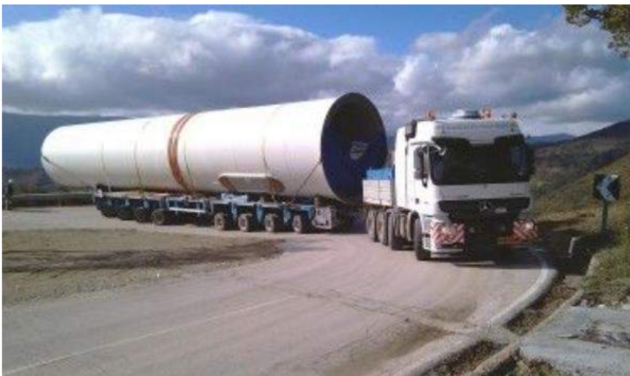
Figure 108 - Soluzione tipo del trasporto dei conchi di torre e adeguamento in curva sulla viabilità esistente
