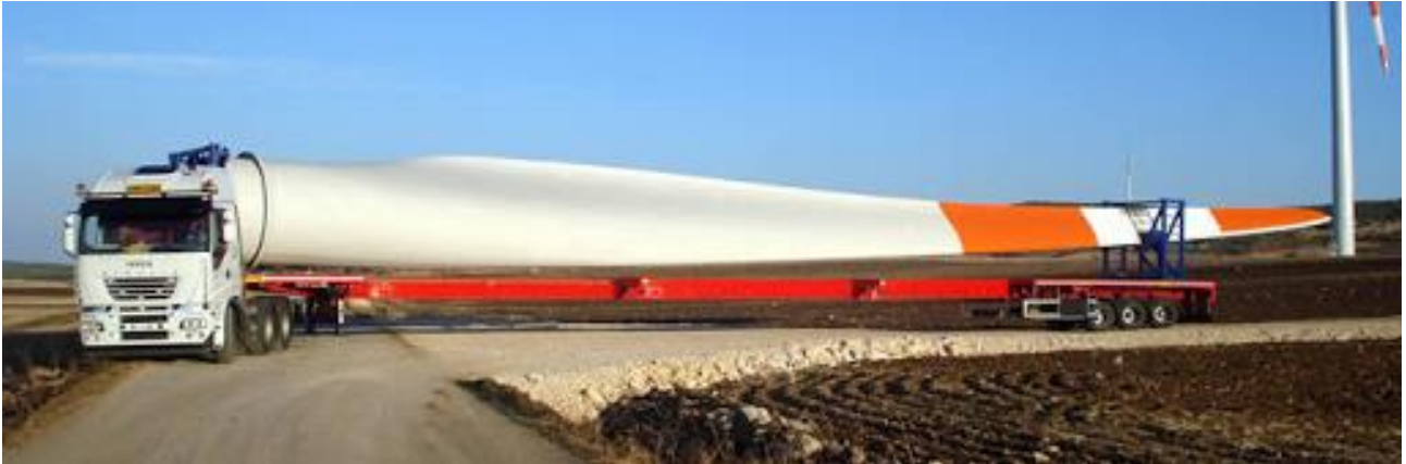
Figure 28 - Soluzione tipo del trasporto delle pale e pista di nuova realizzazione tipo per l'accesso alla turbina
