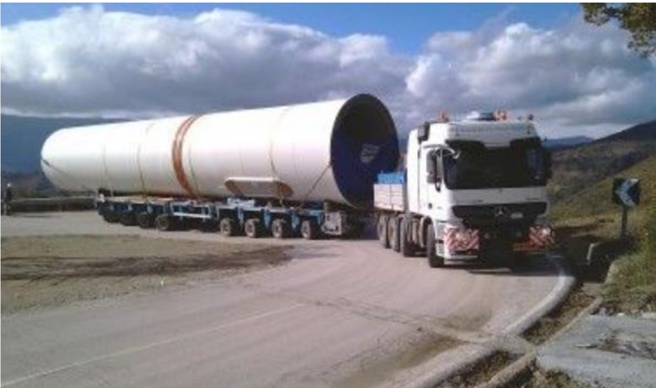
Figure 26 - Soluzione tipo del trasporto dei conchi di torre e adeguamento in curva sulla viabilità esistente
