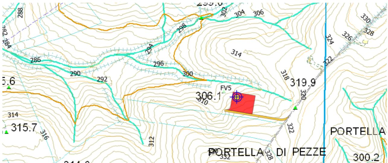
**Figura 7-24–Inquadramento dell'aerogeneratore FV5 rispetto ai corsi d'acqua con curve di livello ogni 2 m.**
