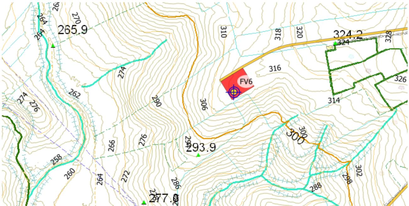
**Figura 7-26– Inquadramento dell'aerogeneratore FV6 rispetto ai corsi d'acqua con curve di livello ogni 2 m.**
