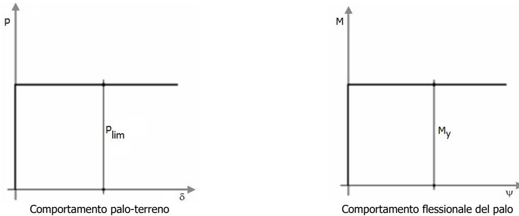
La resistenza limite laterale di un palo è determinata dal minimo valore fra:
