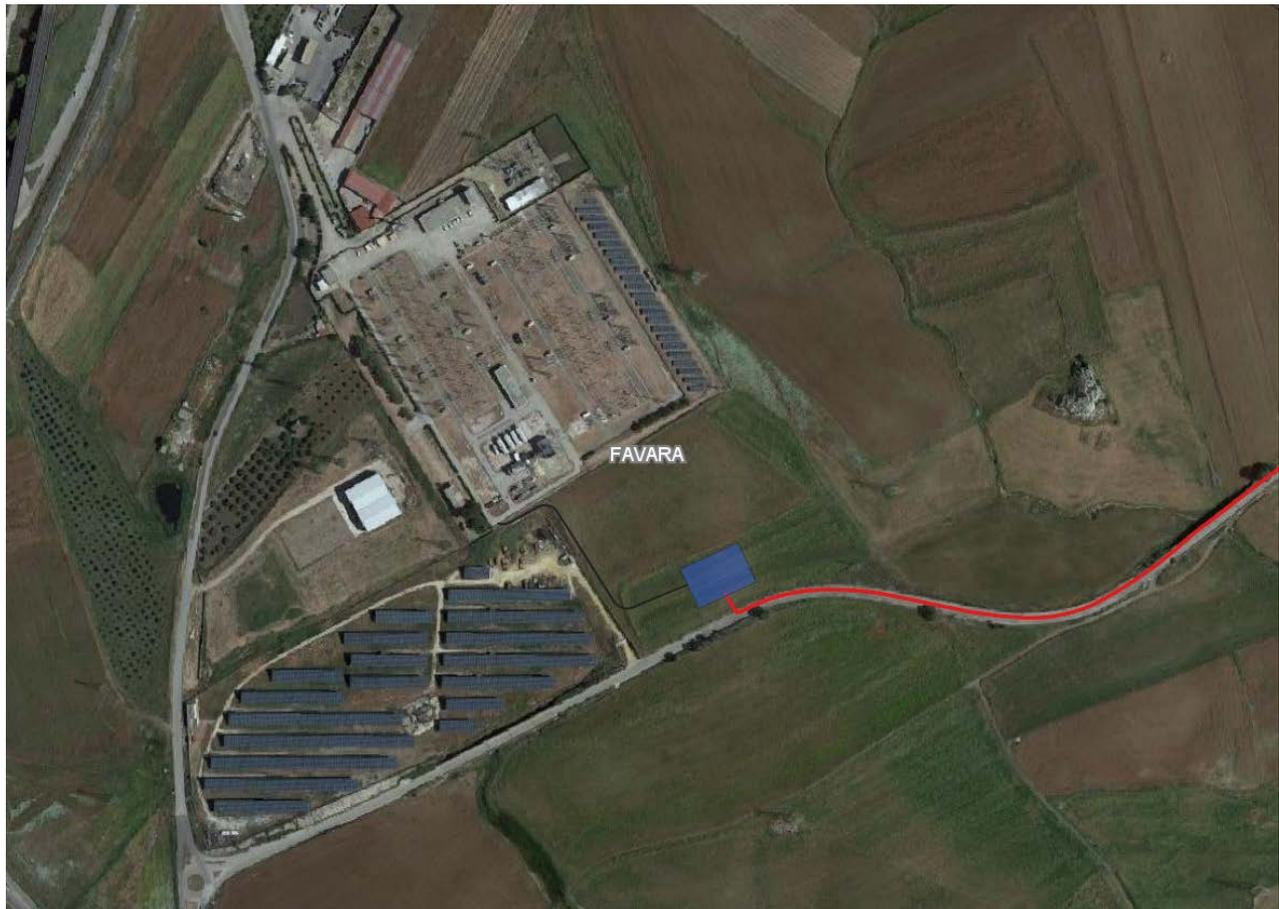
**Figura 7-2 – Dettaglio area di ingombro sottostazione utente (in blu) e collegamento interrato AT alla SE “Favara” (in nero).**
