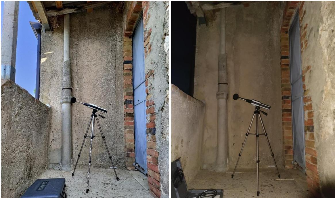
**Figura 4-33 – Esempio collocazione fonometro diurno/notturno**
