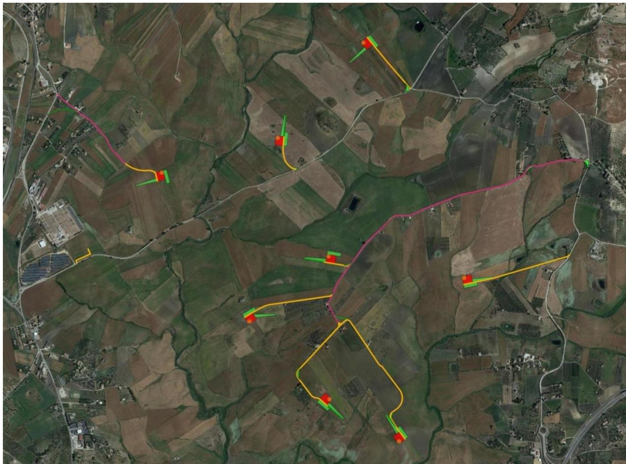
**Figura 3-10 – Strade di accesso al parco eolico di nuova realizzazione (in giallo), strade esistenti da adattare (in colore viola)**
