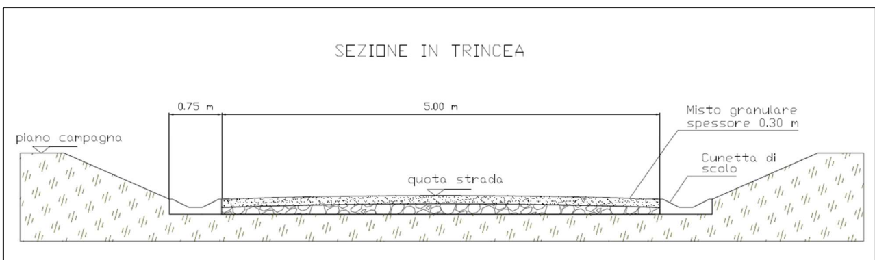
Fig. 9: esempio di tipica strada di accesso al parco eolico
