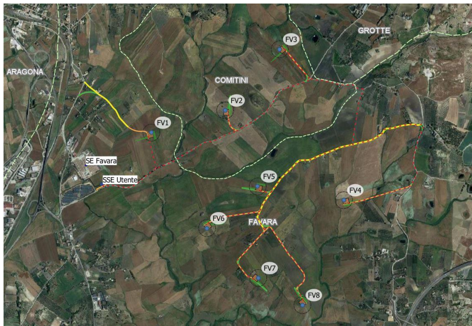
Figura 2 – Localizzazione delle opere su ortofoto (in blu aerogeneratori, in arancio piazzole e piste di accesso, in rosso tratteggiato cavidotto interrato in verde aree di cantiere, in giallo strade da allargare).
