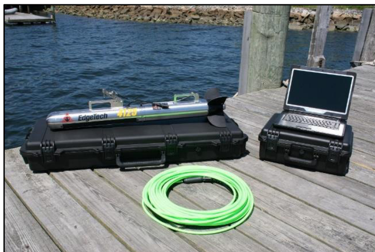
Figura 15-Strumentazione Side Scan Sonar Edgetech 4125 di proprietà della Sigma Ingegneria S.r.l.
