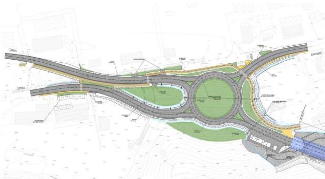
**Figura 13 – Planimetria di progetto dello svincolo Ovest – Nebbiù - Cortina**
