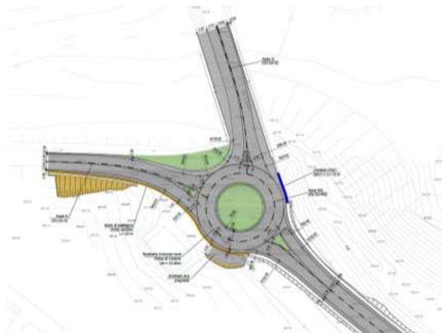
**Figura 16 – Planimetria di progetto dello svincolo Nord – Pieve di Cadore**
