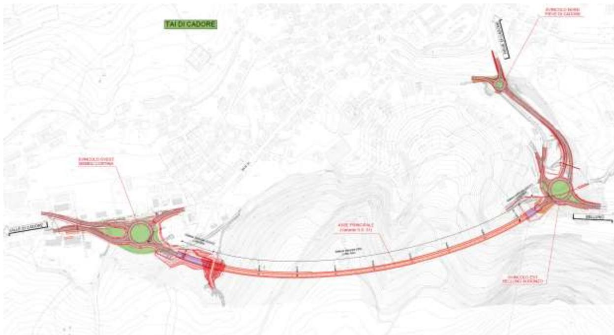
**Figura 8 – Planimetria di progetto del tracciato stradale**
