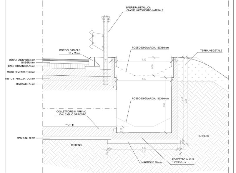
**PARTICOLARE D - SEZIONE C-C - POZZETTO**
