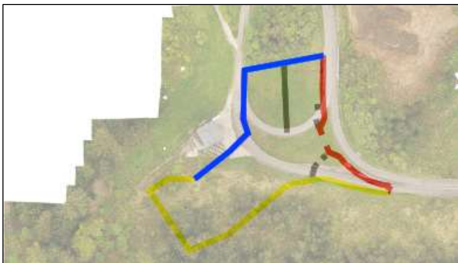
Figura 27 - Introduzione di barriere acustiche (in blu: lunghezza totale 170 m, H=5 m)
