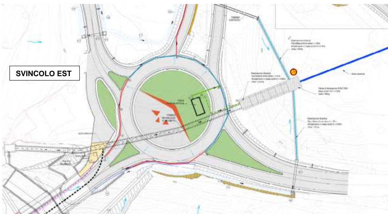
Figura 31: Stralcio planimetrico smaltimento acque meteoriche - imbocco Est
