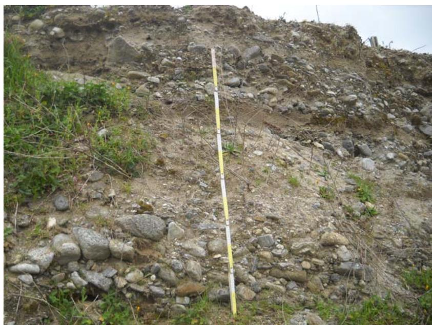
Le intercalazioni sabbiose sono costituite da sabbia debolmente limosa composta prevalentemente da quarzo, feldspati ed aggregati polimineralici di roccia cristallina; all'interno si rinvengono piccoli ciottoli sparsi o allineati nel senso della corrente e subordinate intercalazioni di limo sabbioso.
