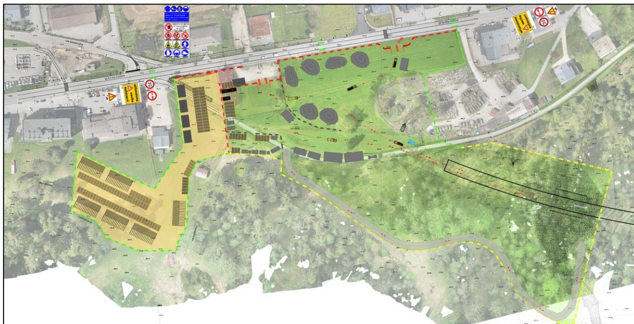
**Figura 4 - Cantiere per la galleria - lato Ovest**
