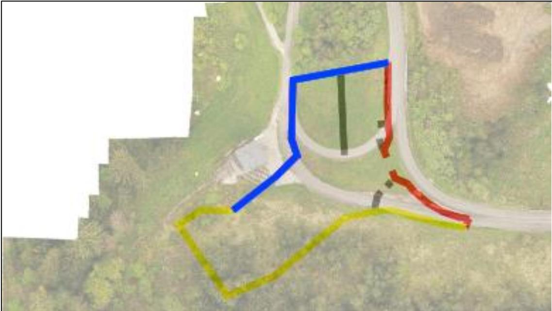
Figura 9 - Introduzione di barriere acustiche (in blu: lunghezza totale: 170 m, H=5 m)
