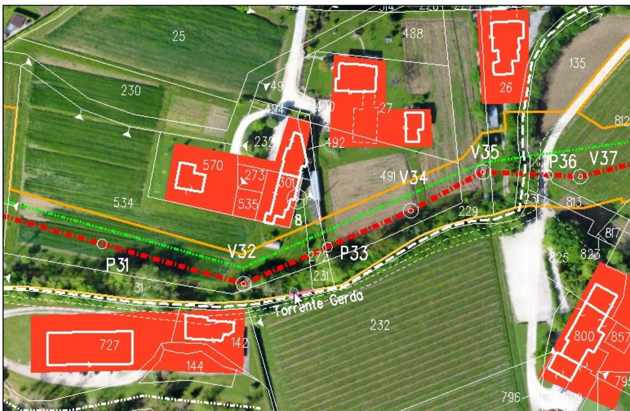
Fig. 1 – Esempio di ricettori (abitato semi-concentrato retino arancione) per i quali prevedere barriere antirumore.
