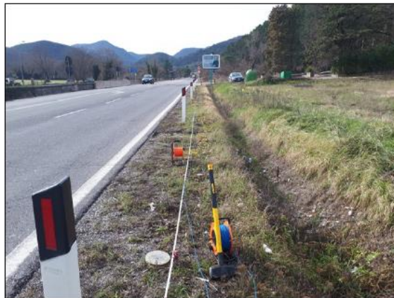
Foto 2 - Esecuzione della prova MASW1
