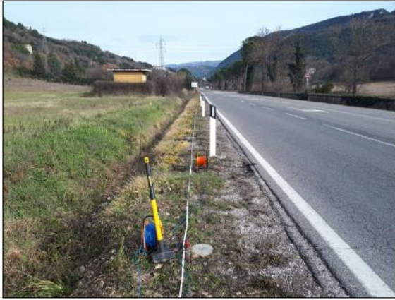
Foto 1 - Esecuzione della prova MASW1
