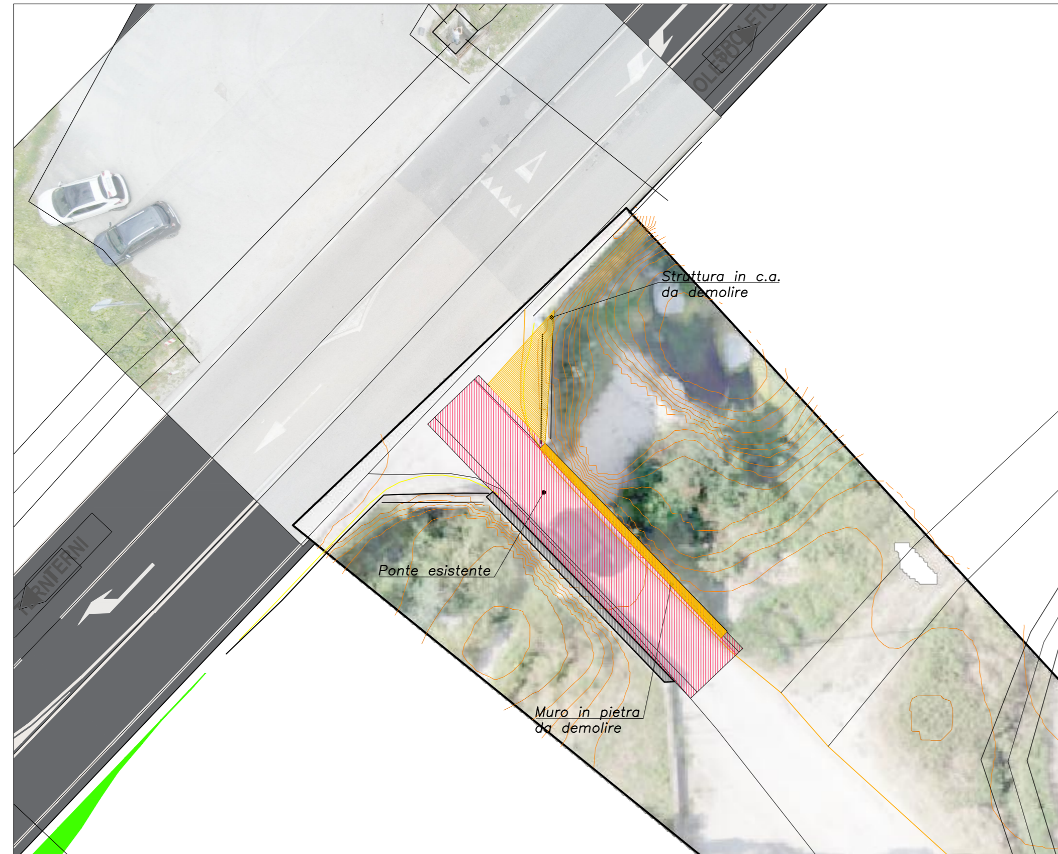
PLANIMETRIA DEMOLIZIONI rapp. 1:200
