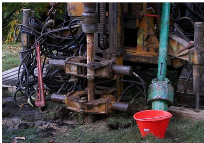
Figura 12: Macchina operatrice per la realizzazione di micropali tubfix. A sinistra sistema di scavo a rotopercussione, a destra sistema di scavo mediante trivella elicoidale.
